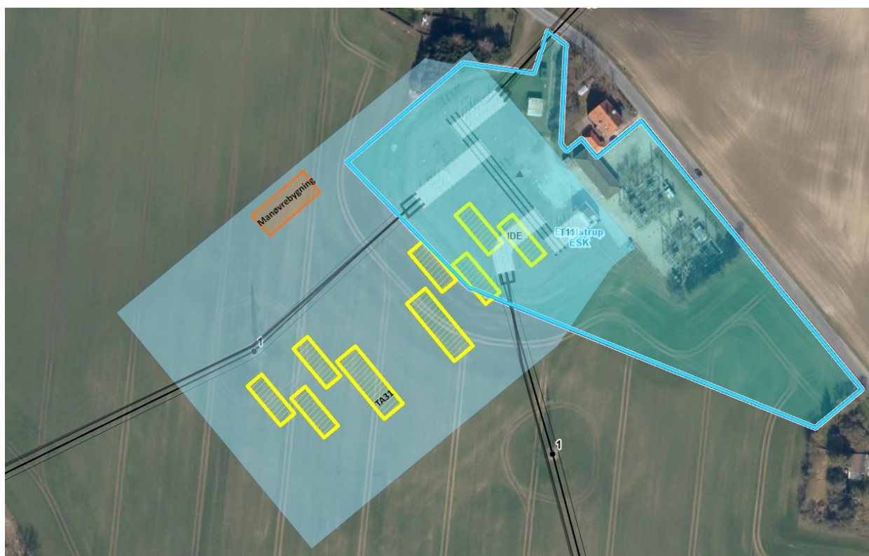
Figur 3-1 oversigt over projektområdet. Stiplet linje markerer ledningsanlægget. Blå firkant markerer det nye stationsareal. Gule firkanter markerer disponible felter, rød firkant markerer placering af manøvrebygning. Sorte linjer markerer eksisterende luftledninger.
